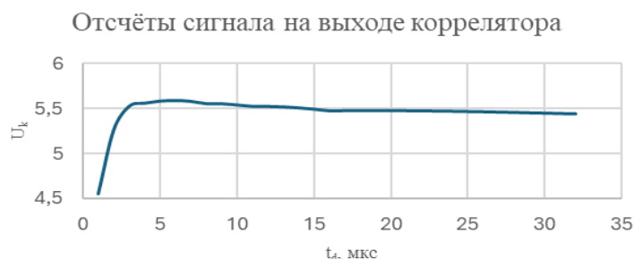
Рис. 5. Отсчёты сигнала на выходе коррелятора для разных значений t_d
